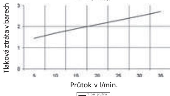
Tlaková ztráta trubky s vnějším průměrem 12L/14S; velikost 8; RVP 24; DN 9,5
